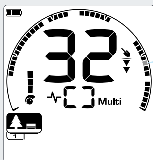
Идентификатор Цели 32 указывает на высоко проводящую цель из цветного металла, (например, монета).
